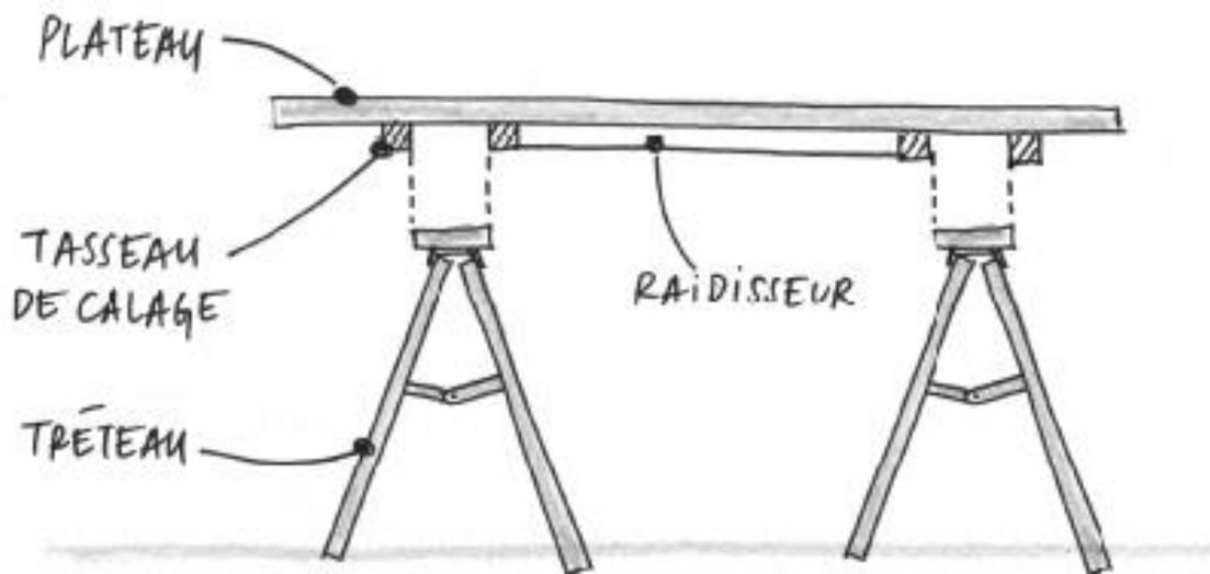
> **Les pieds des tréteaux ne doivent pas être placés l'un en face de l'autre. Dans le cas où le tréteau n'est pas stable, ne pas hésiter à pousser les pieds dans leur axe correspondant.**
